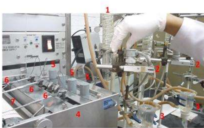
Figura 2. Equipo de mantenimiento de órgano aislado. 1. Ingreso de solución de Krebs. 2. Transductores de señales de mecánica a eléctrica. 3. Contenedores de órganos aislados. 4. Polígrafo. 5. Sistema de plumas e inyección de tinta. 6. Plumitas de inscripción en papel del polígrafo. 7. Papel de registro milimétrico
